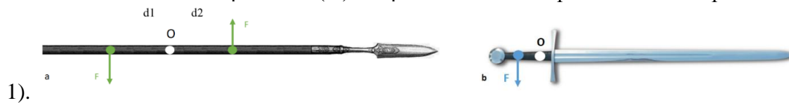
1). Рисунок. 1. Схема елемента техніки фехтування: короткий рубаючий удар без обертання корпусом рогатиною і одноручним мечем ( d_1 = d_2 плечі пари сил).
