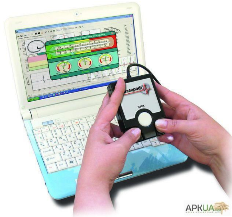
Рисунок 2.2 – Зовнішній вигляд комп'ютерного кардіографу «Фазаграф» із пальцевими електродами
