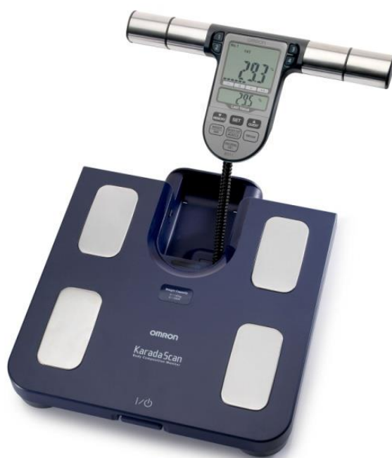
Рисунок 2.1 – Прилад Omron BF511 для визначення показників складу тіла (за біоімпедансометрію)
